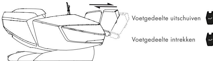
Aan de onderzijde van de voetensteun is een sensor bevestigd, de voetensteun past zich automatisch aan de lengte aan zodra de stoel wordt gestart.
