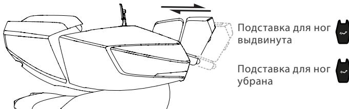
В нижней части подставки для ног установлен датчик, который автоматически регулирует ее длину после запуска кресла.
